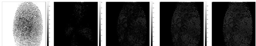
**Figura 2.** Diferentes resultados del detector para la imagen de una huella digital de tamaño  $374 \times 388$  (izquierda) con elementos estructurantes de tamaños  $s \in \{5, 9, 13\}$  y diferente número de orientaciones: de izquierda a derecha  $\{2, 4, 6, 8\}$  orientaciones.
